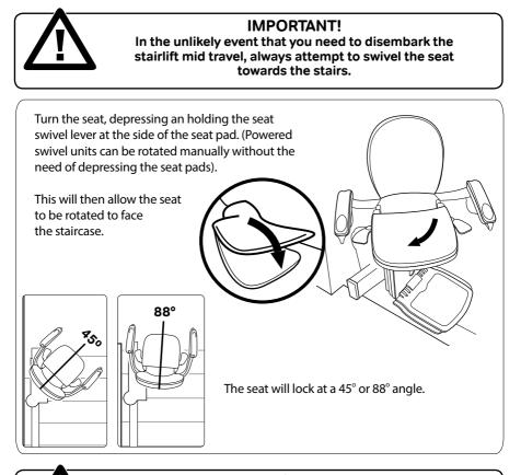
IMPORTANT! MAKE SURE THE SEAT IS LOCKED INTO POSITION BEFORE ATTEMPTING TO DISEMBARK THE STAIRLIFT
